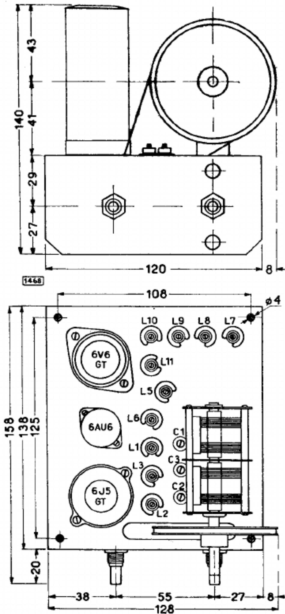
Dati di ingombro, disposizione delle valvole e delle indutture del VFO 4/101.
